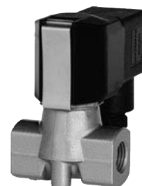
8259 Электромагнитный клапан с прямым управлением без разности давления Латунь или нержавеющая сталь DN 1,5–5 (0–25 бар)
